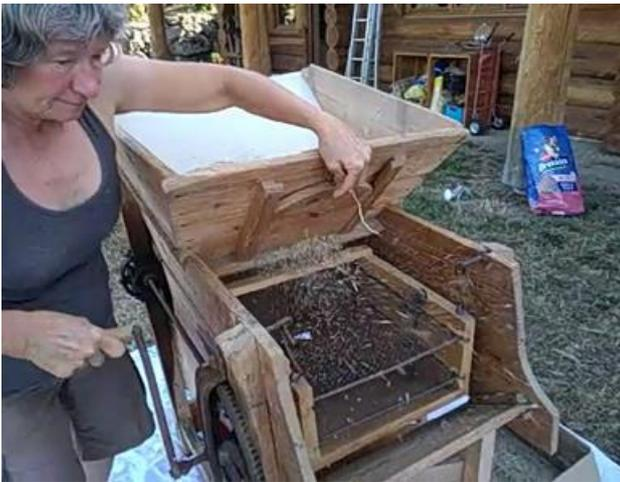
Le nettoyage des grains se fait au tarare (vannoir).
